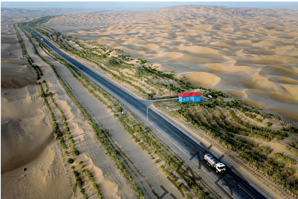
图2-30 塔克拉玛干沙漠石油公路两厢的防护林带
